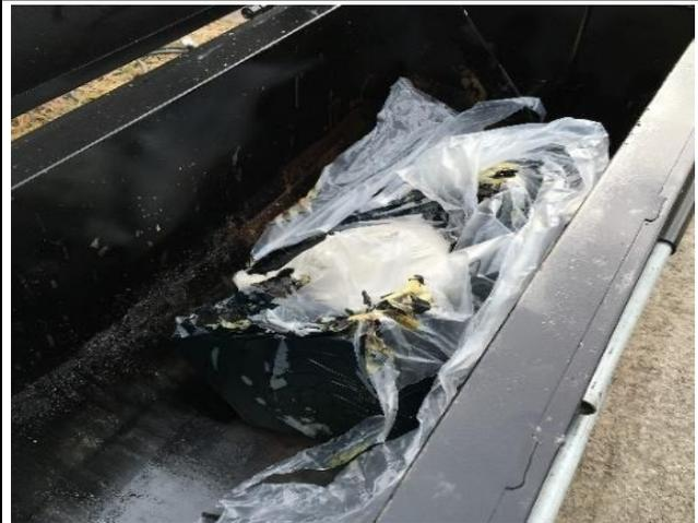
2. 材料溶解 ミニメルター30（溶解釜）に箱からあけて、材料を取り出し、そのまま投入し、火をつけます。1回目は3箱まで入れられます
